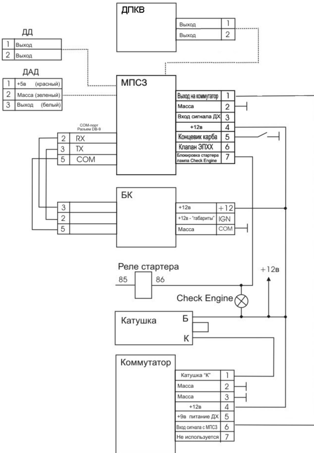
При работе от ДПКВ и использовании двухканального коммутатора и сдвоенной катушки
