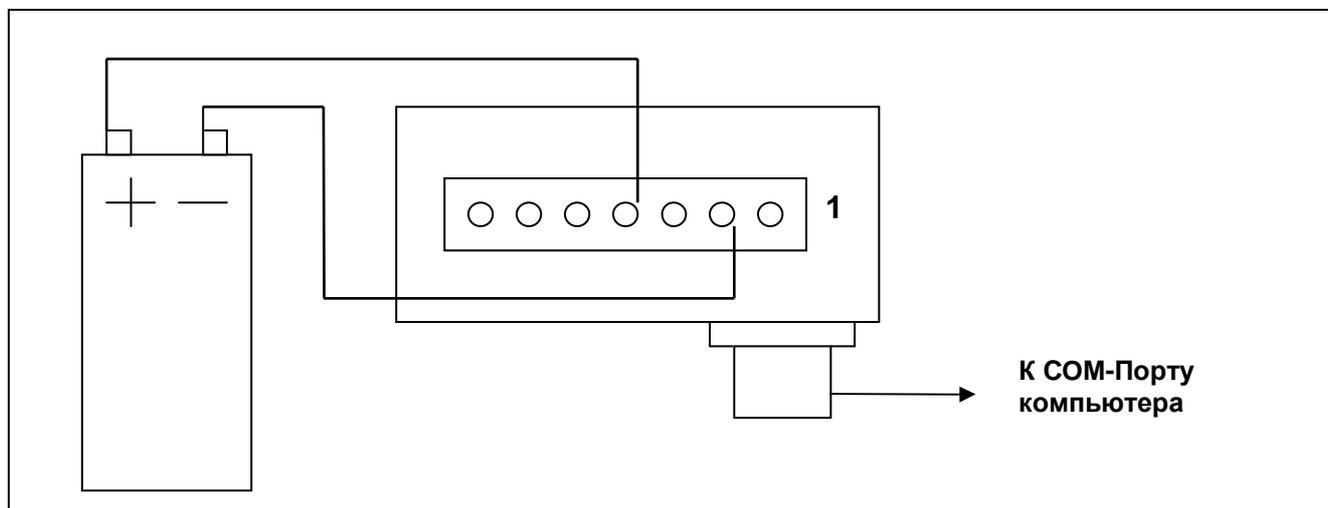
Плюс питания подсоединяем на 4-й вывод МПСЗ, минус – на 2-й. Подключаем ДАД к МПСЗ и подключаем устройство к СОМ-порту компьютера с помощью кабеля «Удлиннитель СОМ-порта».
